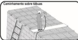
É necessário andar durante a montagem e concretagem sobre tábuas. Nunca pise diretamente no tijolo. Molhar bastante a laje, antes do lançamento do concreto para evitar que as peças absorvam a água do concreto. Nunca acumular concreto em um só local da laje, para não criar uma carga concentrada na laje. Usar 105 litros de areia e 105 litros de pedra zero e 1 saco de cimento CPE II 32 e 26 litros de água (areia média úmida) ou 19 litros água (areia muito úmida).
